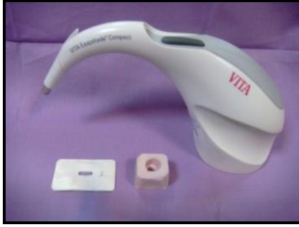
Resim 4. Renk ölçüm cihazı ve ölçümün yapılmasında kullanılan kalıp
