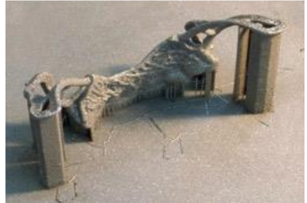
Resim 1. Sinterleme işlemi tamamlanan iskelet altyapı 28
