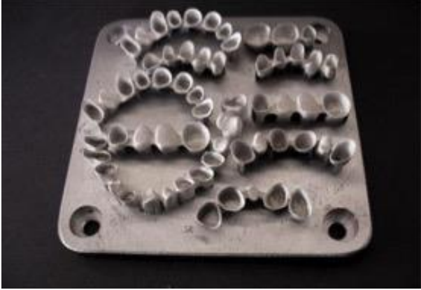
Resim 3. Sinterleme tablasındaki metal altyapılar 34
