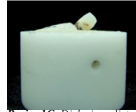
Resim 1C. Dişlerin polister rezin içerisine gömülmesi.
