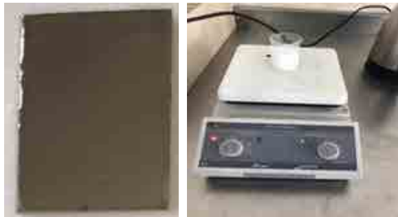
Şekil 1. (a) AISI 1010 karbon çeliği altlık numunesi (b) etanol ve nano-Al 2 O 3 çözelti karışımı
